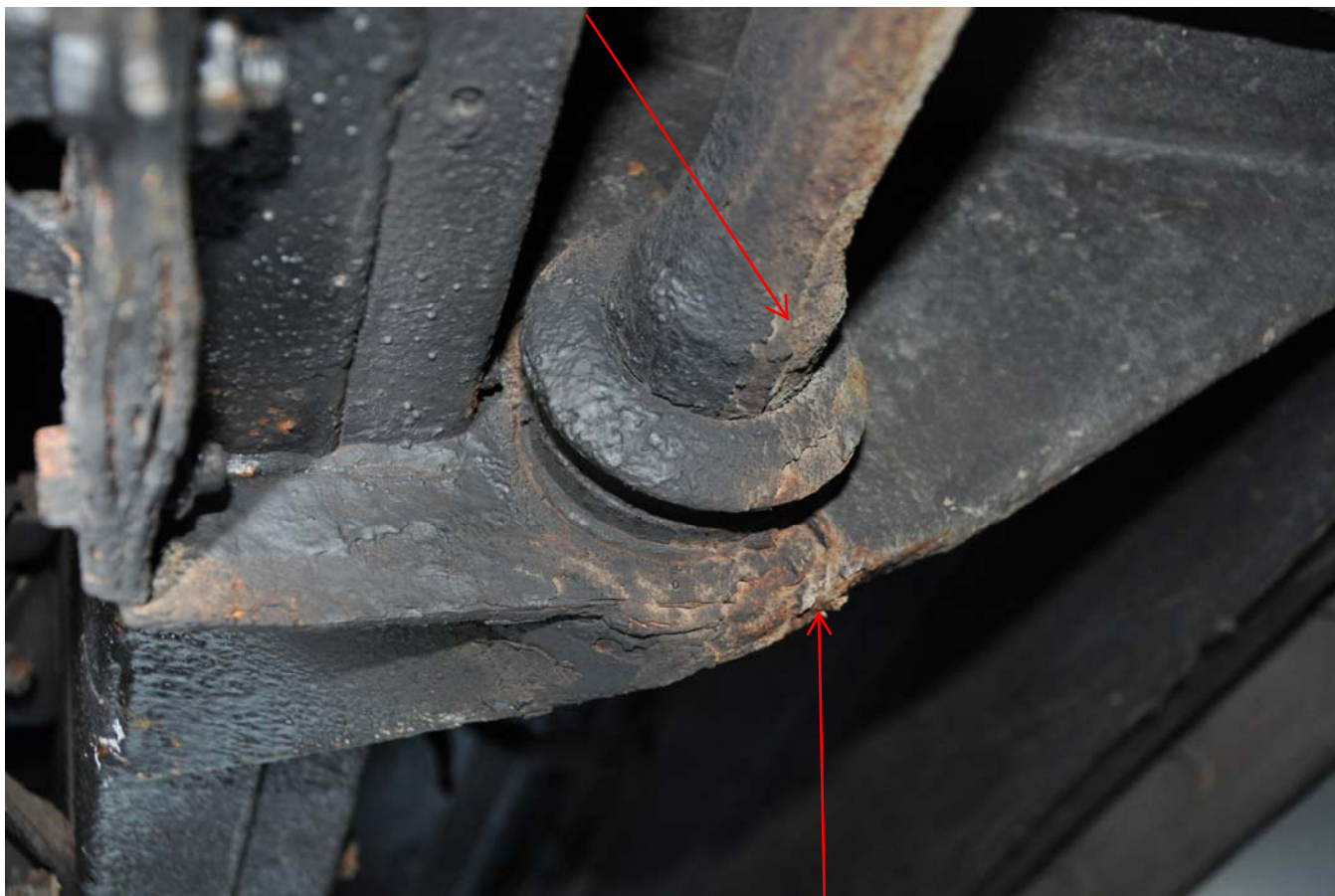
Stabilisatoren stark angerostet
