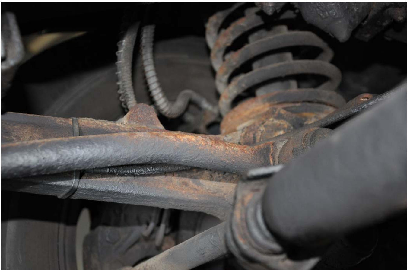
Korrosion an der Hinterachse
