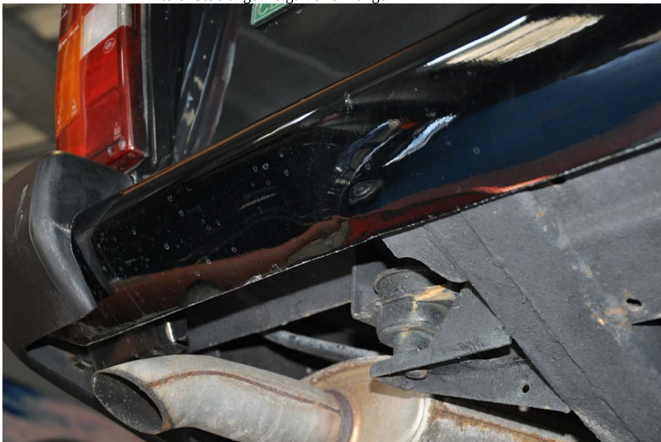
hinterer Stoßfänger zeigt Verformungen
